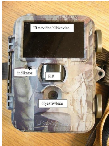
Slika 3: Avtomatska kamera namenjena spremljanju prisotnosti medveda in drugih vrst prostoživečih živali na krmišču. Označeni so glavni sestavni deli kamere.
