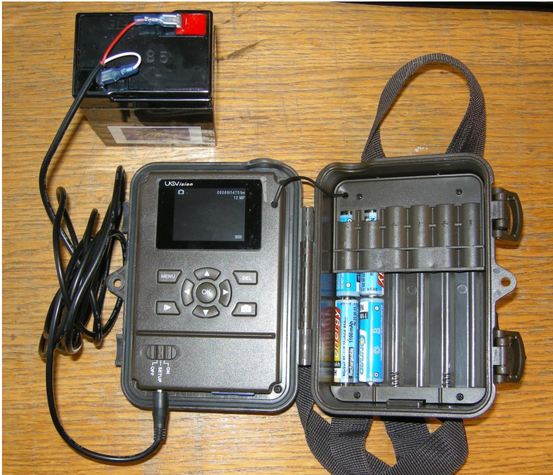
Slika 2: Priklop akumulatorja na kamero.
