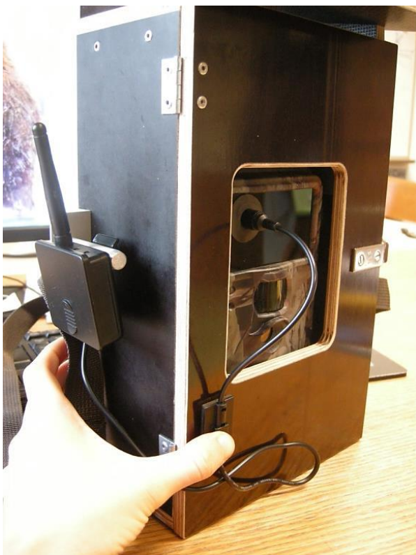
Slika 4: Pritrditev oddajnika na leseno ohišje in pritrditev gooseneck senzorja na kamero.
