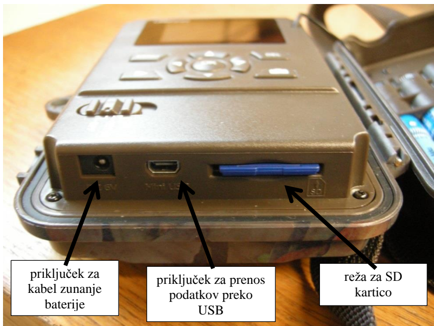
Slika 5: Prikluček za zunanjo baterijo, prikluček za prenos podatkov na računalnik in reža za SD kartico.
