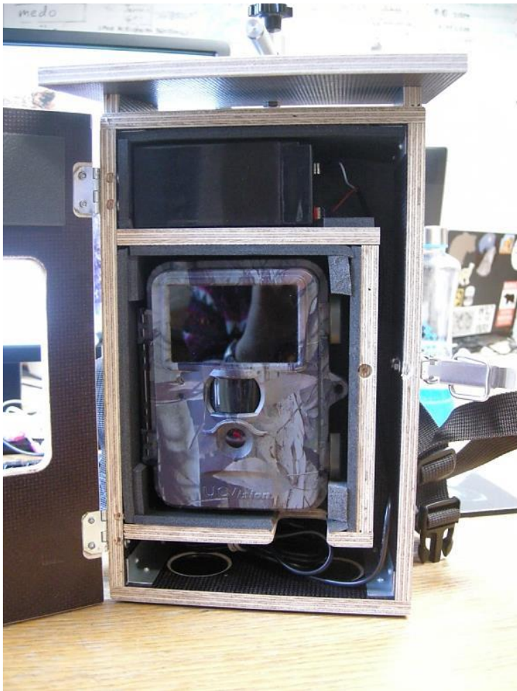
Slika 1: Razporeditev opreme v notranjosti lesenega ohišja.
