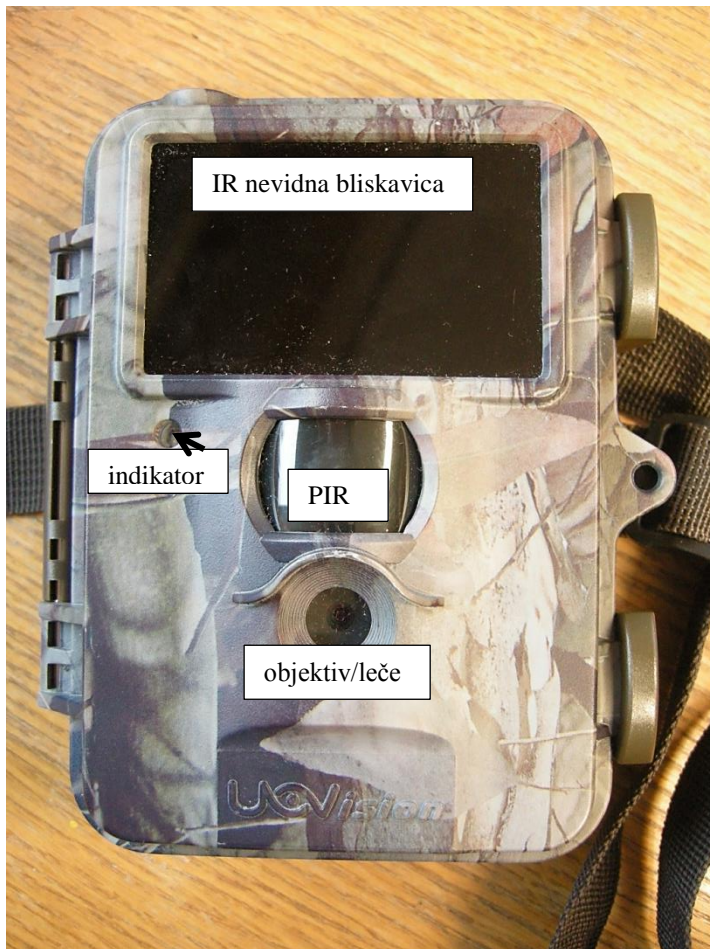
Slika 1: Sprednja stran kamere (PIR = pasivni infrardeči senzor, ki zaznava prisotnost živali).
