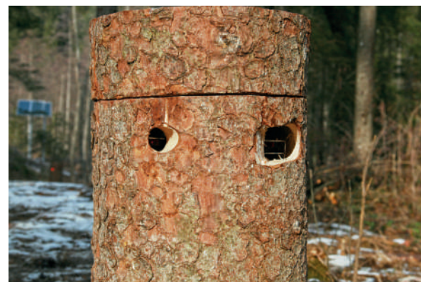
Senzorji za zaznavo divjadi so nameščeni v lesenih stebričkih.
