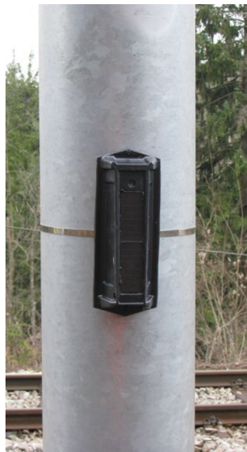
Zvočna odvrtača, ki so nameščena na električne drogove ob železniški progi.
