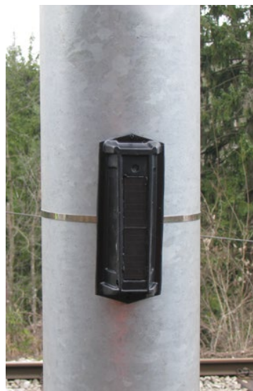
In Slovenia, per ridurre le collisioni treno-orso, sono stati installati dei dissuasori acustici su pali elettrici lungo i binari della ferrovia.
